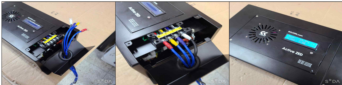
(3) 3상4선을 고무커버 통과 후 고정 설치 단자대(R,S,T,N) 각상의 위치 확인
